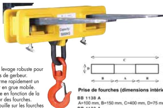
Bloc de levage robuste pour fourches de gerbeur. Transforme rapidement un gerbeur en grue mobile. Réglable en fonction de la longueur des fourches. Se verrouille sur les fourches avec une poignée à vis. Le crochet est fixé et équipé d'une sécurité.
