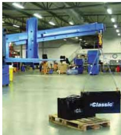
Grue à gerbeur pratique pour par ex. le levage de machines lourdes, le déplacement de moteurs etc. La grue est réglable en hauteur jusqu'à 40° avec trois positions depuis la position horizontale. Longueur totale avec bras déplié de 3600 mm. Largeur totale 500 mm. Tunnels de fourches repliés 160x60 mm. Equipé de blocage des fourches ainsi que des pieds repliables et blocables.
